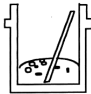
Silinder diisi 1/3 batu pecah dan dirojok 25 kali
